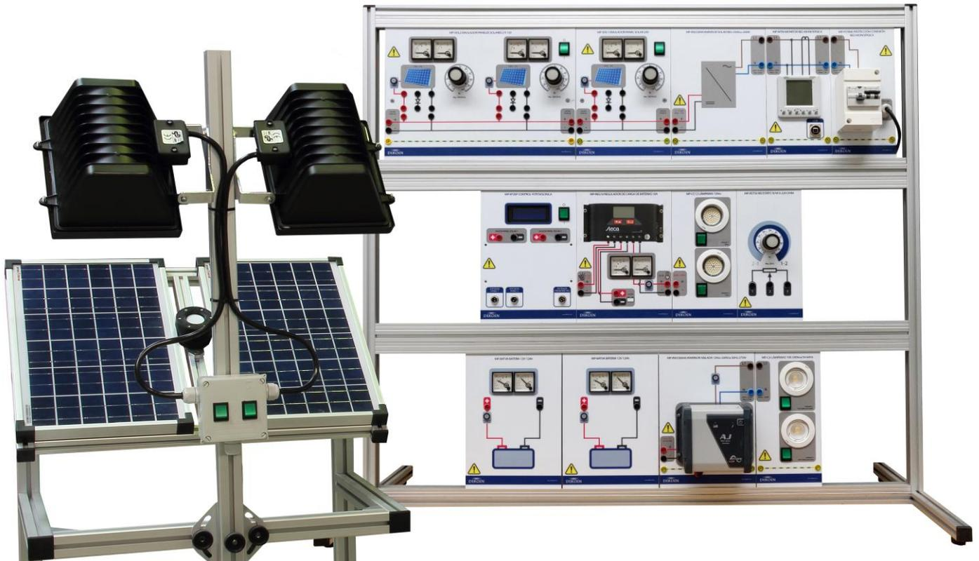
El equipo EN 01.5 reproduce a escala una instalación solar fotovoltaica completa. Se ha diseñado con especial hincapié el aspecto didáctico del mismo, pudiéndose observar a primera vista todos los componentes que tiene una instalación solar fotovoltaica y su disposición.
